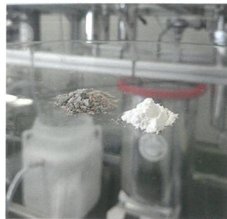
Aus Abbruchbeton wird synthetisches Calciumcarbonat (Precipitated Calcium Carbonate – PCC) gewonnen. Das PCC ist hochrein, weiß und fein und kann in dieser Qualität als Füllstoff und Pigment in Papier, Kunststoff, Farbe, Lack oder bauchemischen Produkten eingesetzt werden.
