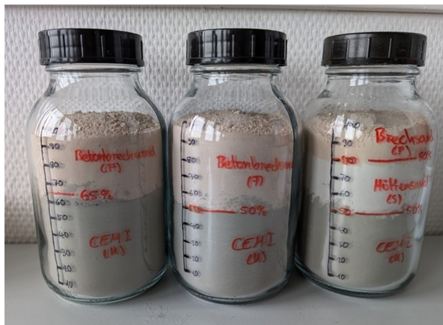
Abbildung 5: Zusammensetzung der untersuchten Kompositzemente (v. l. n. r. CEM II/B-F, CEM II/C-F, CEM II/C-M (S-F) (M. Denu)
