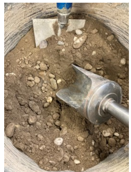
Abbildung 6: Mischung der mineralischen Betonkomponenten (J. Gleß)
