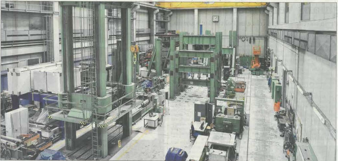
**Einzigartig in dieser Form:** Die Prüfhalle bietet eine hohe Flexibilität. Materialien können an kleineren Stationen oder auch an den großen grünen Anlagen getestet werden. Im hinteren Bereich der Halle kann die Anlage an der Aufspannplatte beliebig angepasst werden – ein mit Lego vergleichbares Stecksystem. Foto: Hora
