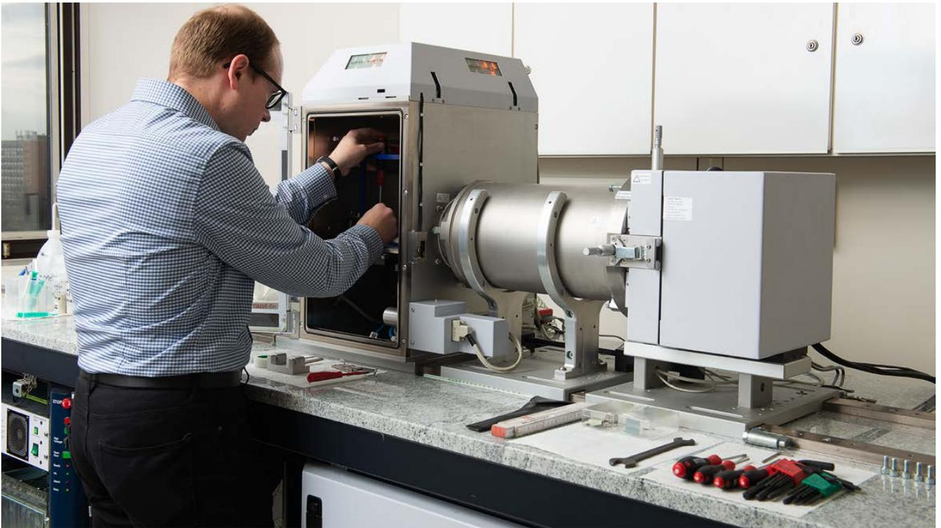
Mikrostrukturanalyse mittels Röntgenkleinwinkelstreuung
