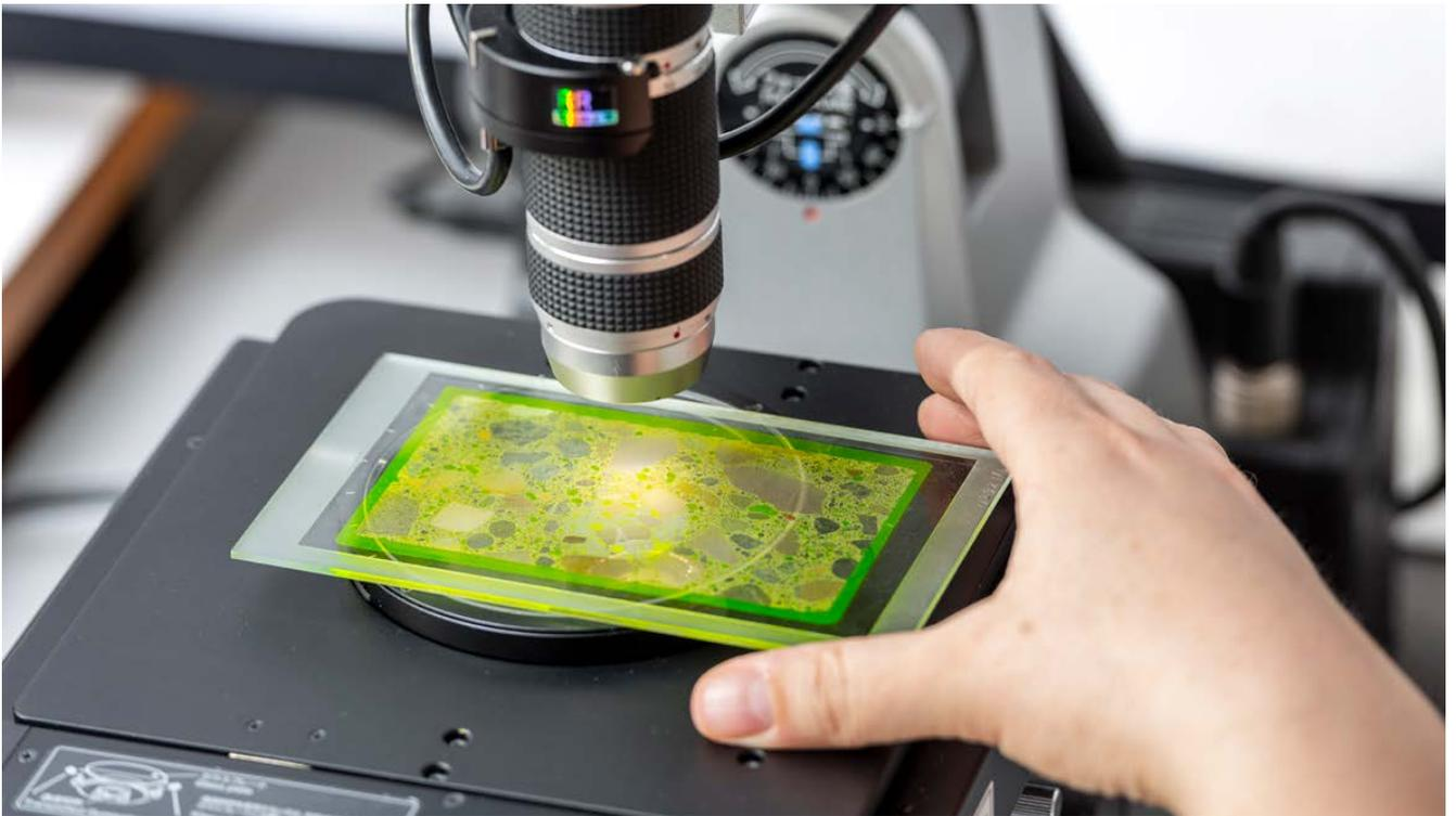
Mikroskopielabor mit Lichtmikroskopen für eine bis zu 5000fache Vergrößerung und 3D-Analytik
