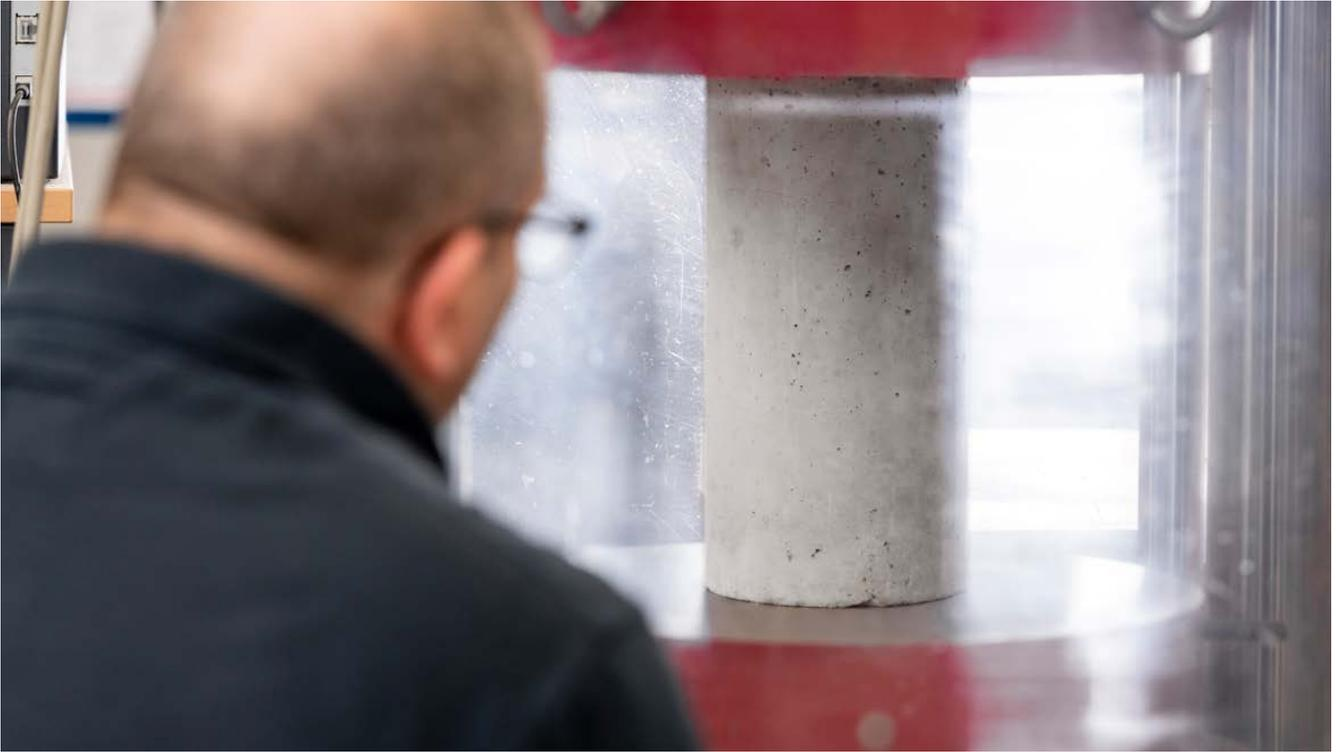
Probenahme und Ermittlung der Druckfestigkeit
