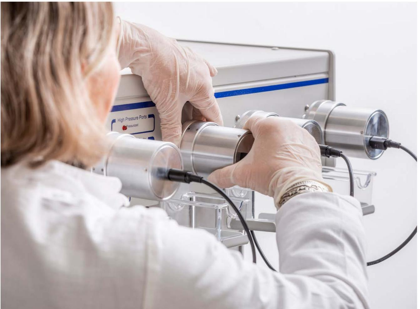
Quecksilberdruckporosimeter für die Analyse der Porengrößenverteilung mit bis zu 400 MPa im Hochdruckport
