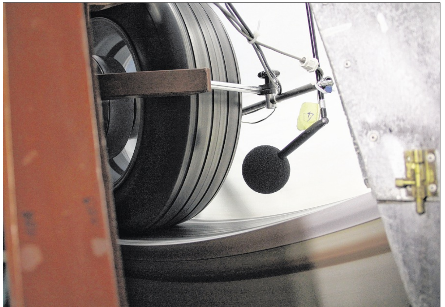
DEM GERÄUSCH AUF DER SPUR: Am Karlsruher Institut für Technologie wird auf eher ungewöhnlichen Wegen versucht, den Verkehrslärm zu reduzieren. So geht es in zwei Projekten darum, leisere Reifen und Straßenbeläge zu entwickeln. Foto: KIT
