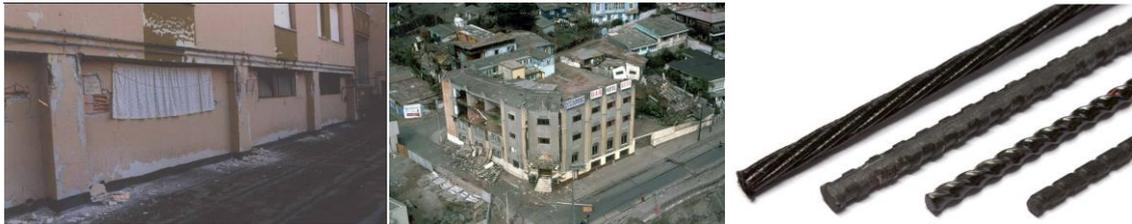
Bewehrung aus Faserverbundkunststoffen (FVK-Bewehrung) weist eine hohe Zugfestigkeit, ein geringes Eigengewicht, eine hohe Korrosionsbeständigkeit sowie eine geringe Wärmeleitfähigkeit auf und findet daher im Bauwesen immer häufiger Anwendung. Diese flächen- oder stabförmige Bewehrung unterscheidet sich im Tragverhalten, Verbundverhalten sowie in der Steifigkeit von klassischer Betonstahlbewehrung.
