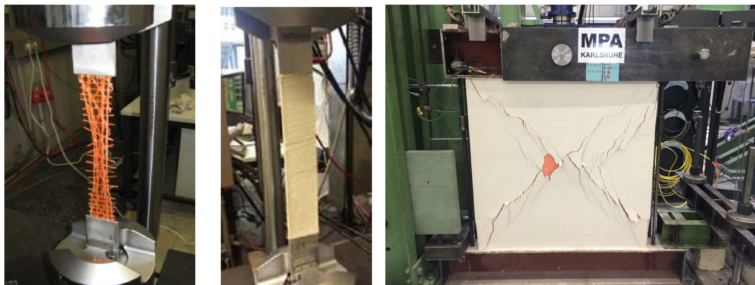
Abbildung 2: Zugprüfungen und zyklische Wandschubversuche
