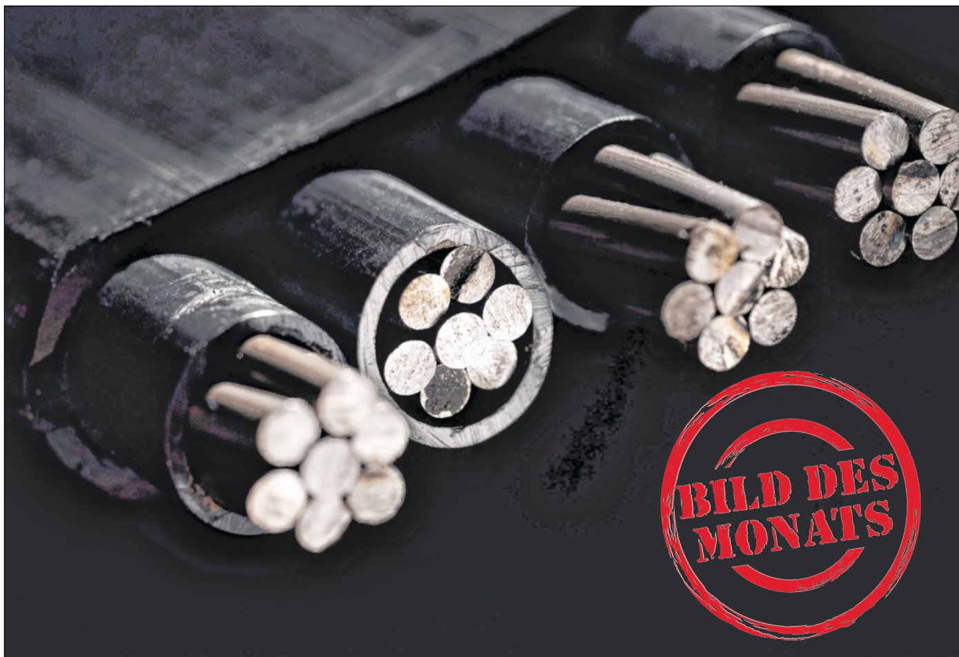
UNTER SPANNUNG: Derartige Stahlkabel werden beim Spannen von Brücken eingesetzt. Ihr Zustand lässt sich mit einem neuen digitalen Schnelltest kostengünstig und mit geringem Aufwand bestimmen. Foto: KIT
